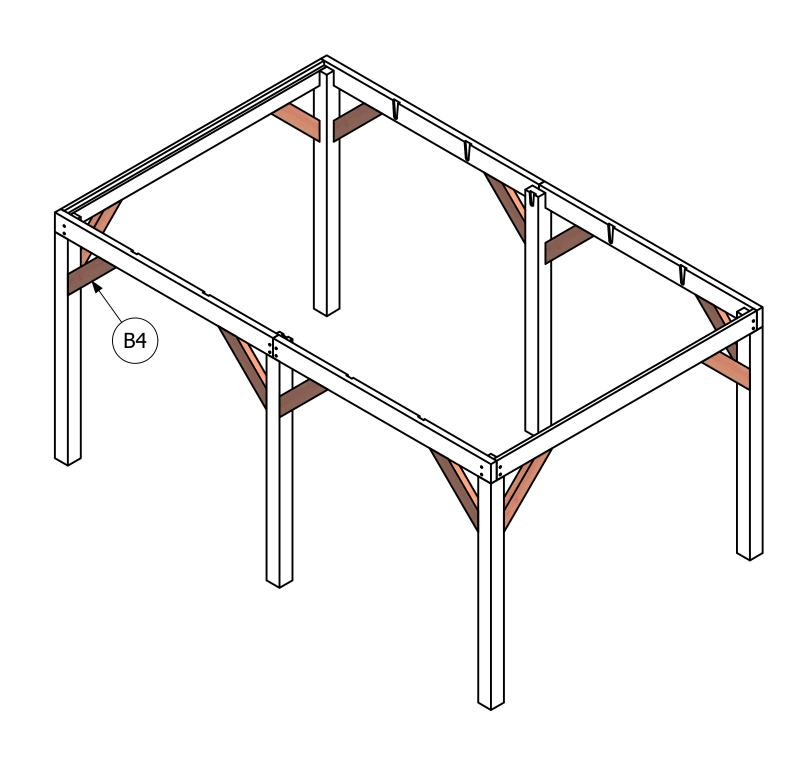
Die Querstreben nur da montieren, wo keine Wände installiert werden. Zuerst die Schrauben festdrehen, danach die Zapfen/Noppen anbringen.
