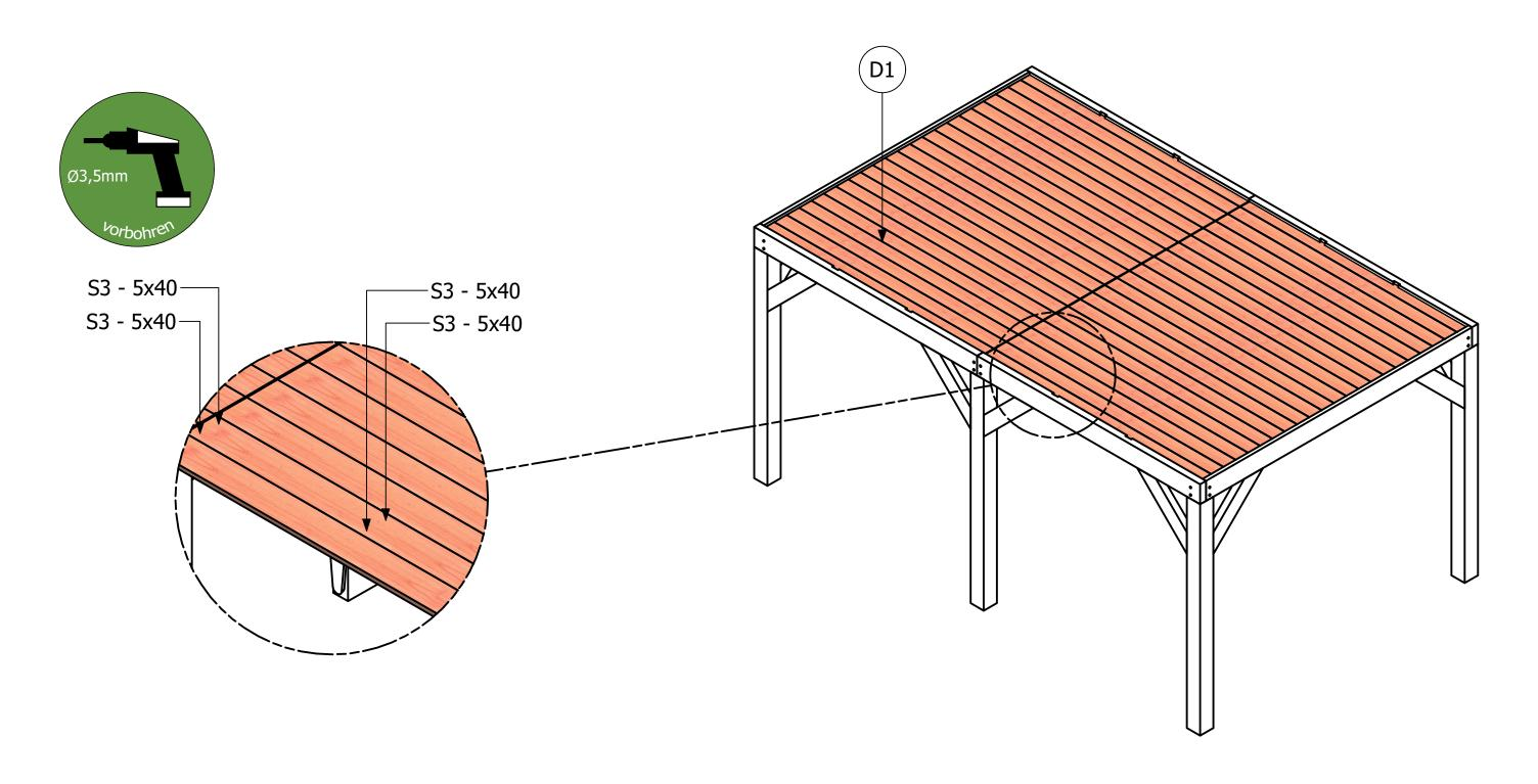
Die Dachbretter platzieren, mit je 2 Schrauben 5x40 pro Dachbrett und Dachbalken (siehe Detailzeichnung der Dachbretter) befestigen. Die Löcher für die Enden der Dachbretter mit einem 3,5-mm-Bohrer vorbohren, um ein Ausreißen zu verhindern (siehe Detailzeichnung der Dachbretter). Das letzte Dachbrett auf die passende Länge sägen.
