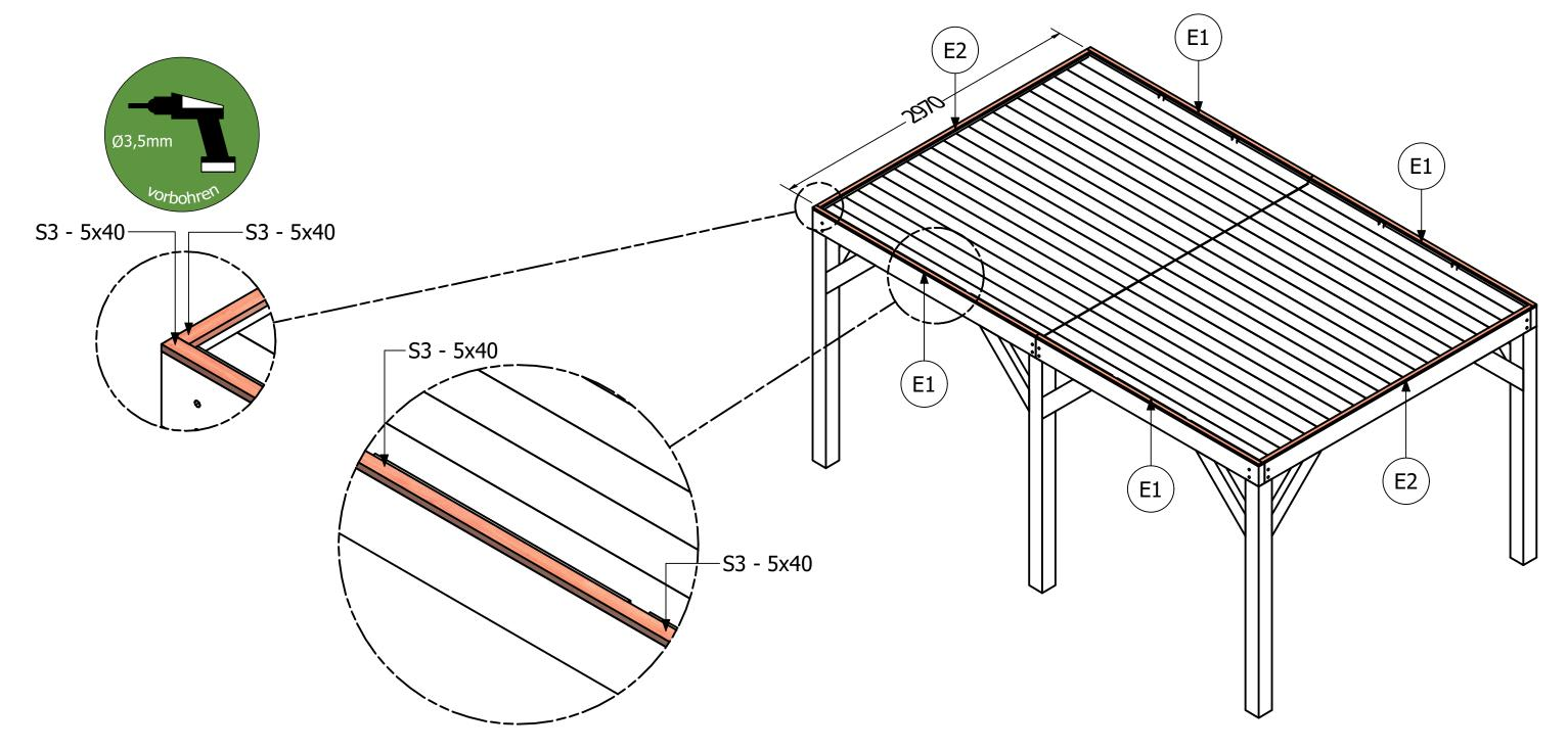
Die Dachabschlussleisten montieren. Darüber wird eine Dachbedeckung wie z. B. EPDM-Folie verlegt, danach muss eine Dachleiste angebracht. Die Dachverkleidung muss die gesamte sichtbare Dachleiste abdecken.
