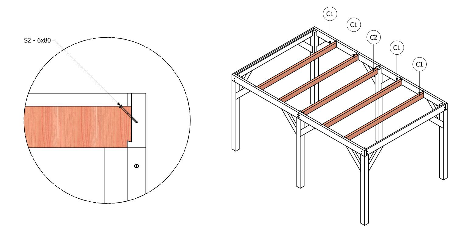
Die Dachbalken platzieren und schräg in die Dachringbalken (Schrauben 6x80) verschrauben. Achtung: mittig wird Dachbalken C2 montiert (kürzeres Maß).
