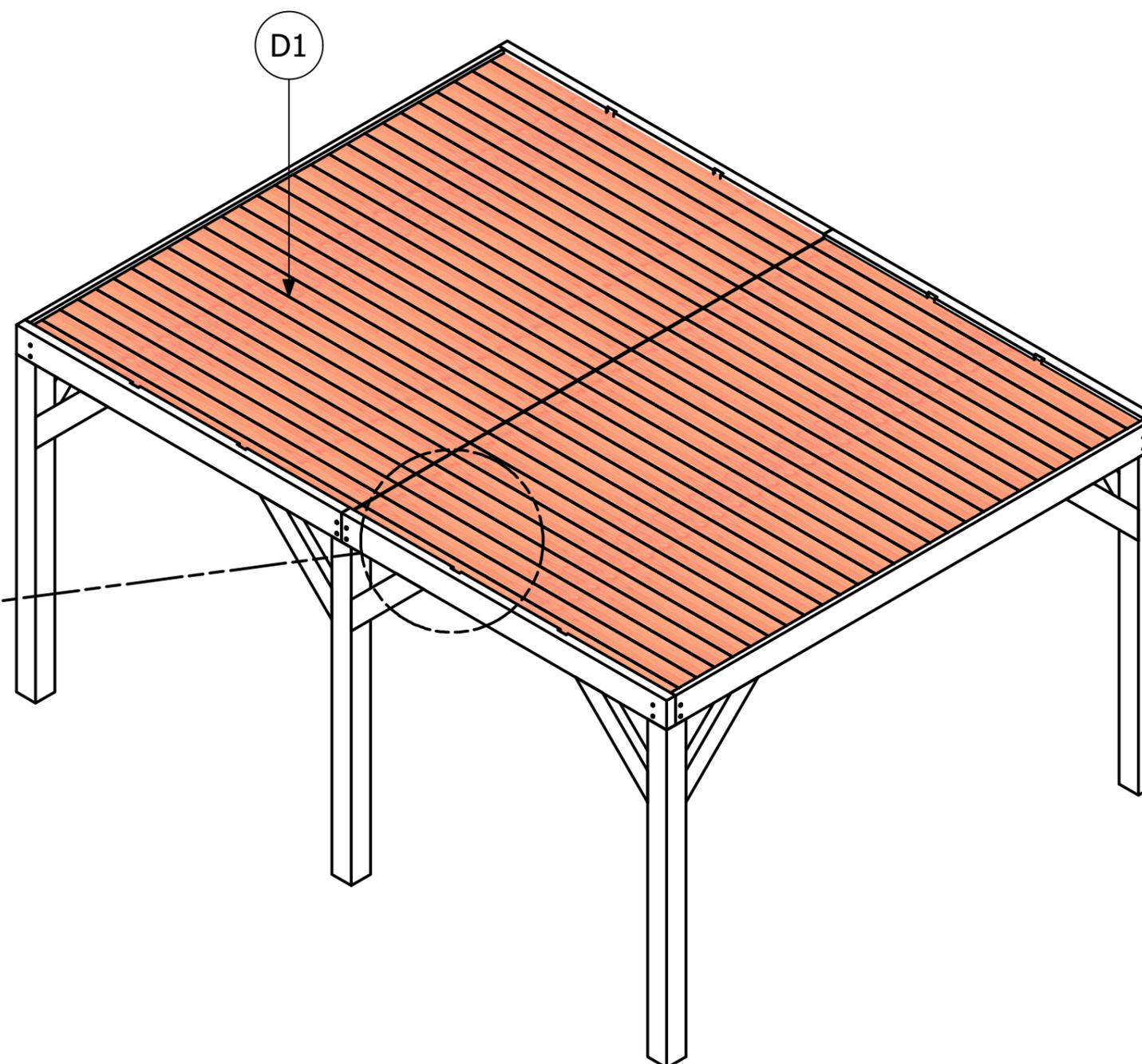
Die Dachbretter platzieren, mit je 2 Schrauben 5x40 pro Dachbrett und Dachbalken (siehe Detailzeichnung der Dachbretter) befestigen.
