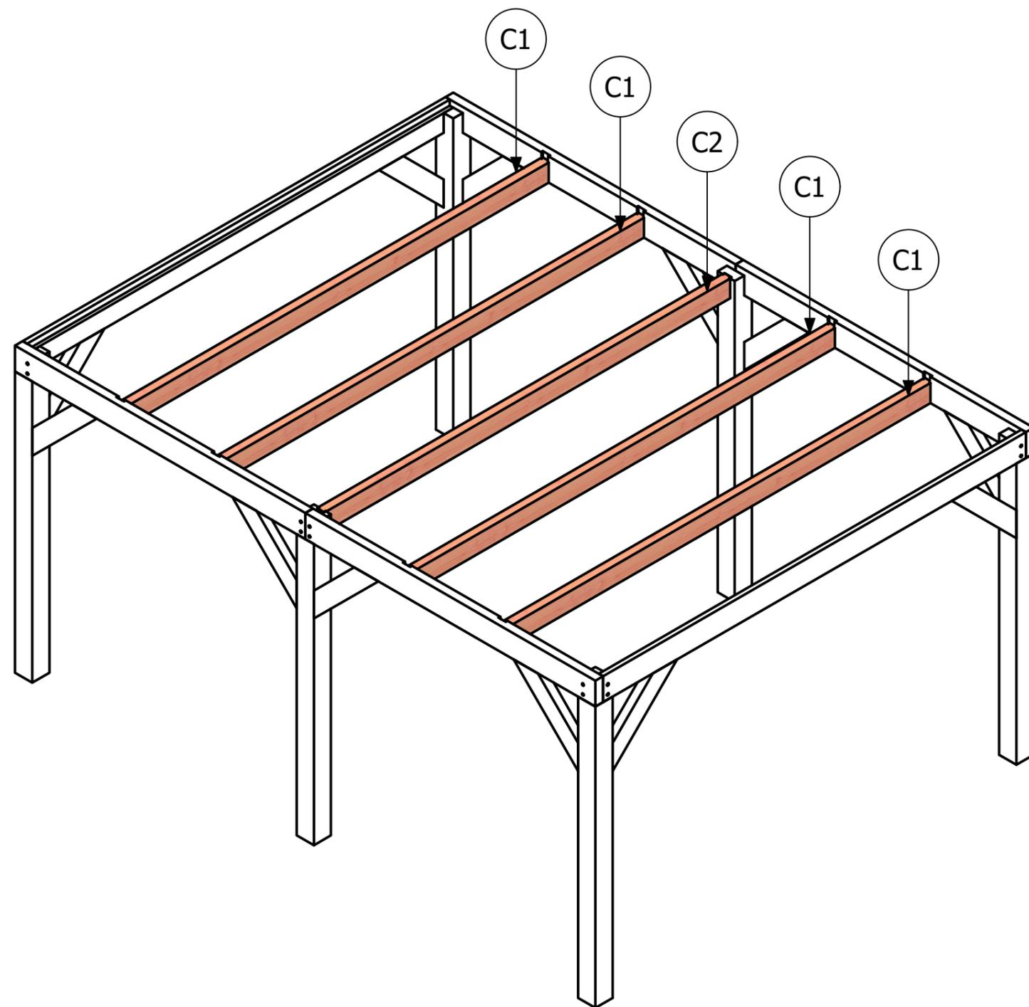
Die Dachbalken platzieren und schräg in die Dachringbalken (Schrauben 6x80) verschrauben.
