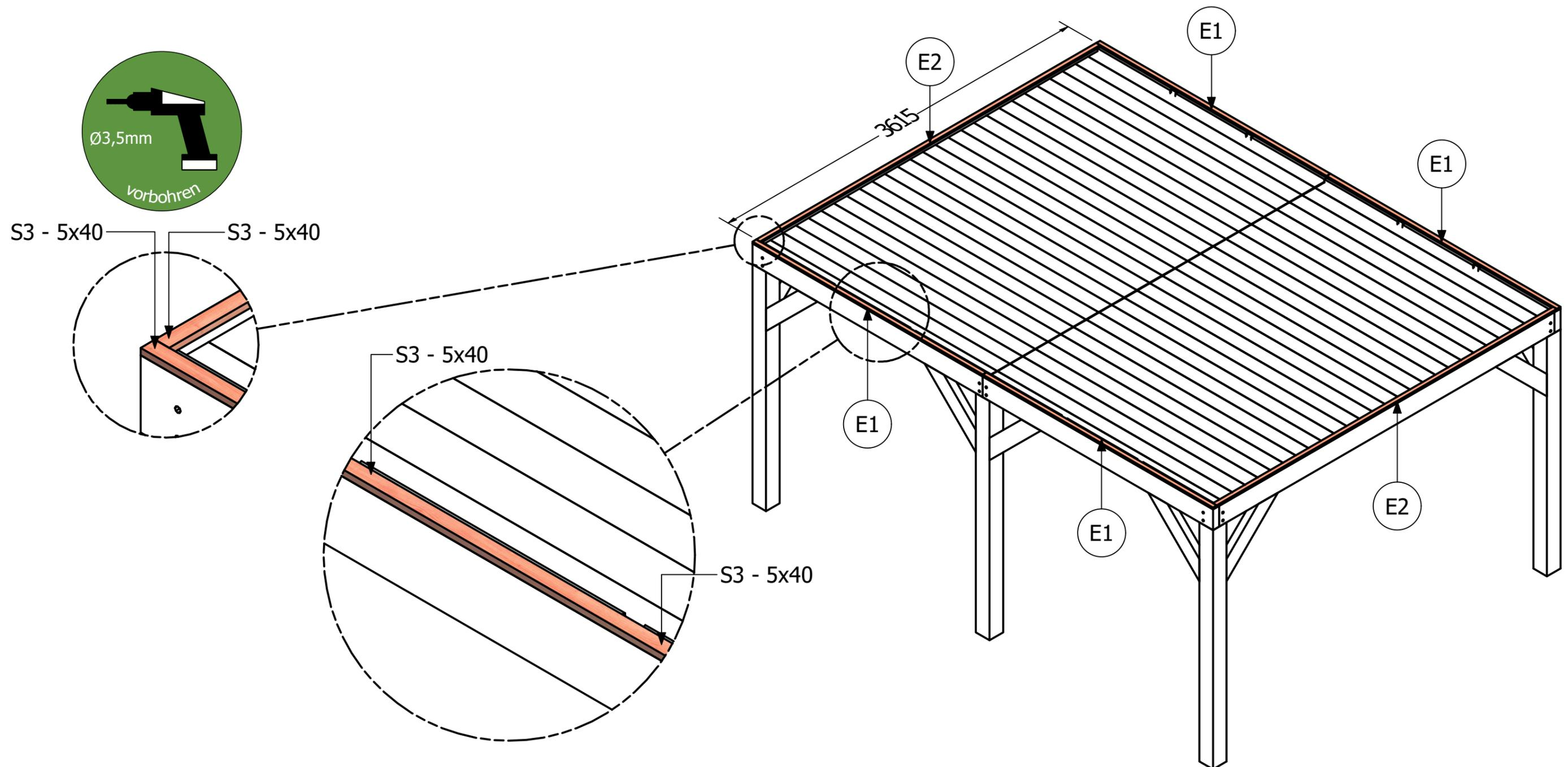
Die Dachabschlussleisten montieren. Darüber wird eine Dachbedeckung wie z. B. EPDM-Folie verlegt, danach muss eine Dachleiste angebracht. Die Dachverkleidung muss die gesamte sichtbare Dachleiste abdecken.
