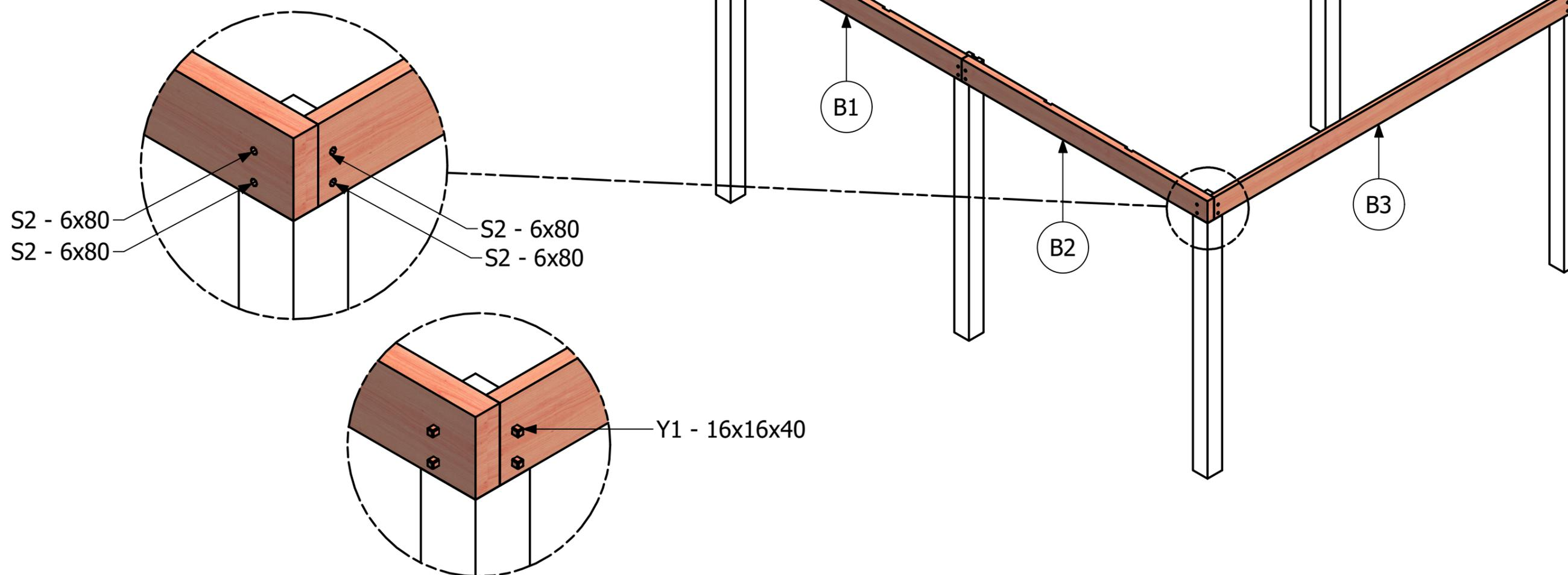
Danach die Dachringbalken festschrauben mit Schrauben 6x80. Danach die Zapfen/Noppen anbringen.
