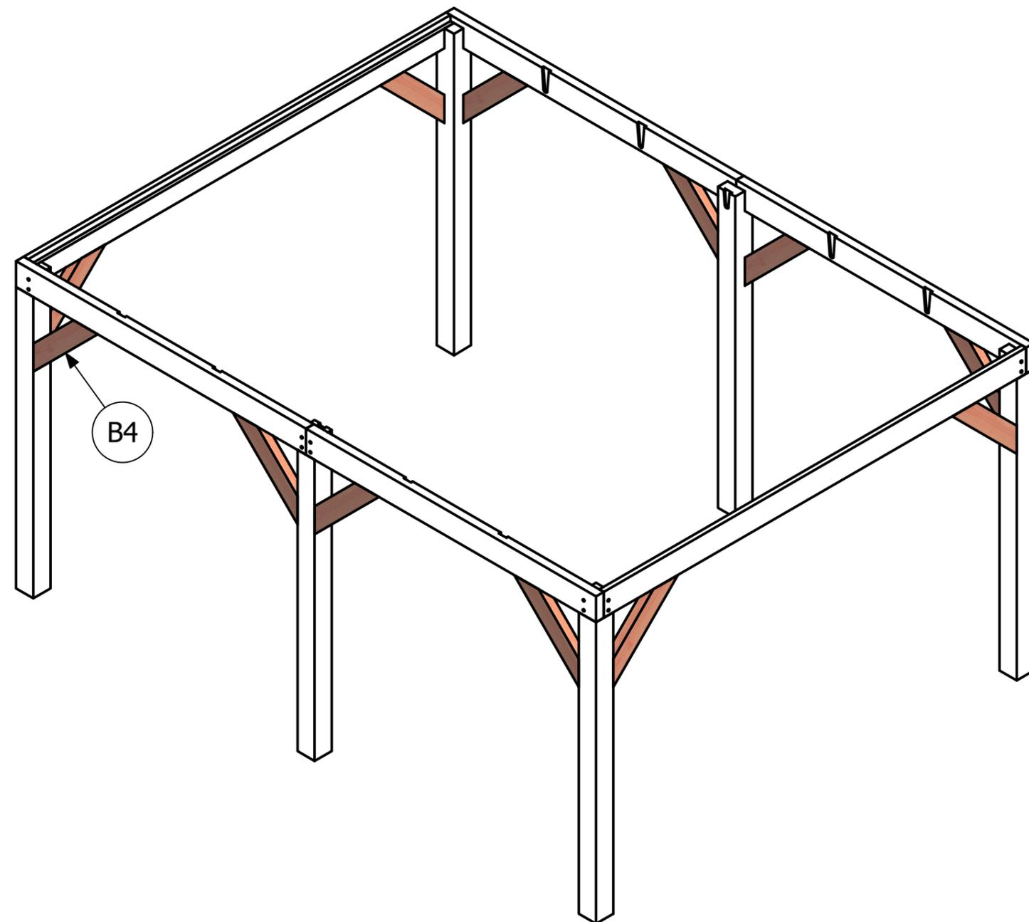
Die Querstreben nur da montieren, wo keine Wände installiert werden.
