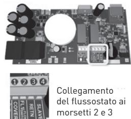
Collegamento del flussostato ai morsetti 2 e 3
