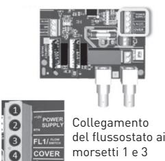
Collegamento del flussostato ai morsetti 1 e 3
