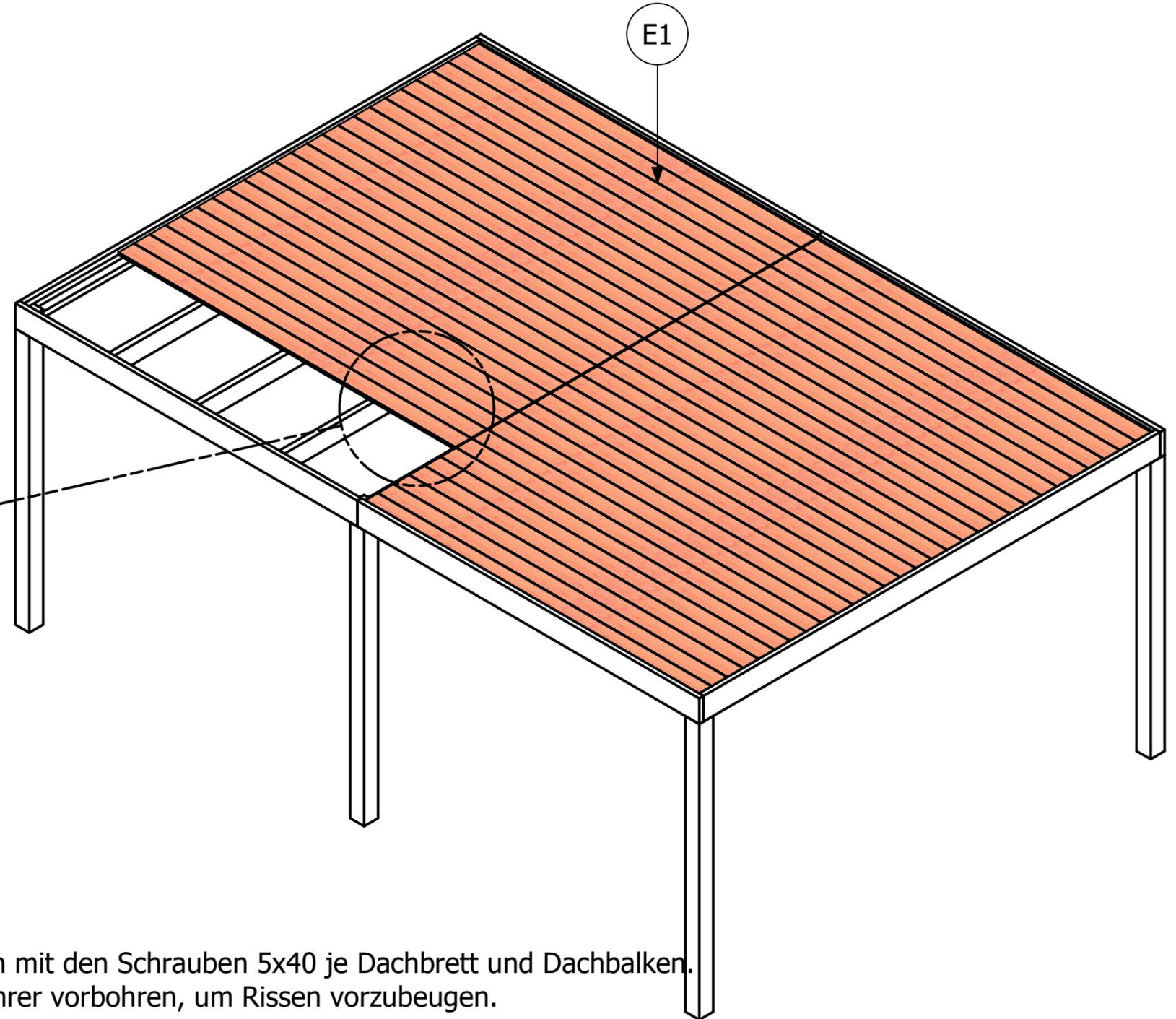
**SCHRITT 1** Platzieren Sie die Dachbretter und schrauben Sie diese an mit den Schrauben 5x40 je Dachbrett und Dachbalken.
