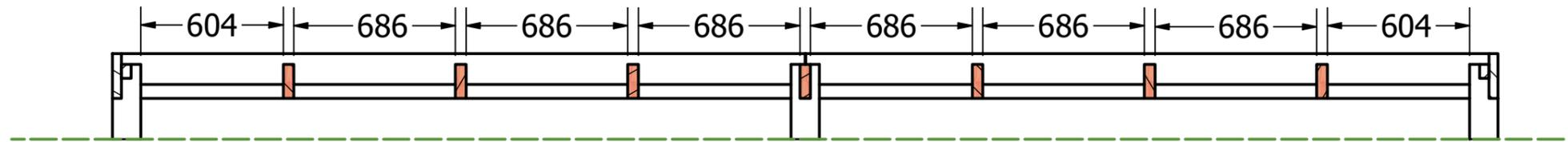
Im späteren Aufbau werden die Dachbalken anmontiert, bitte auf gleichmäßige Abstände achten.
